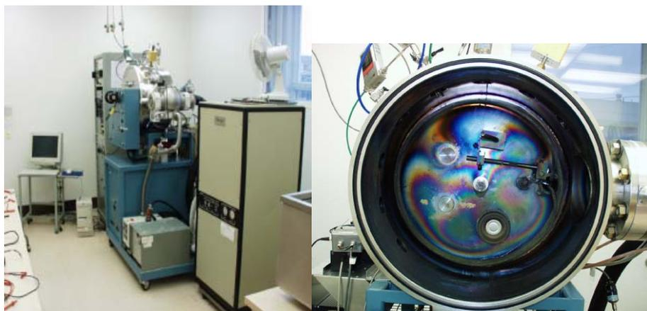
*Figure 8 : Système Corona Vacuum Coater ancien modèle et vue à droite de l'enceinte à vide.*
