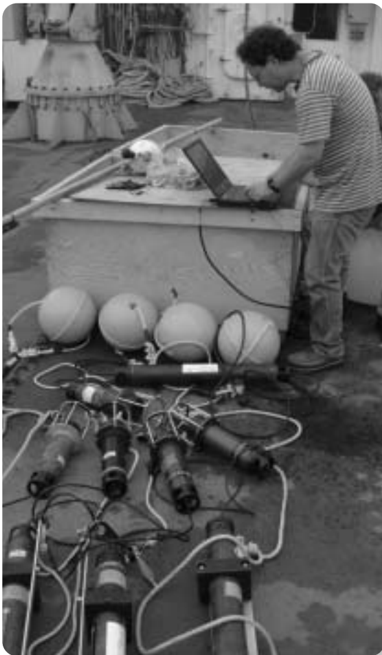
Essai du réseau acoustique sous-marin Seaweb pour le projet canado-américain de système rapidement déployable (RDS-4)
