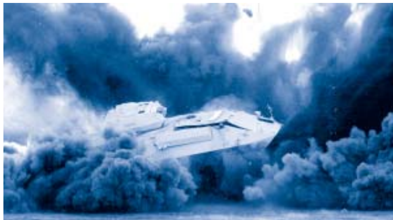
Essai d'explosion d'une mine terrestre sous un véhicule blindé léger
