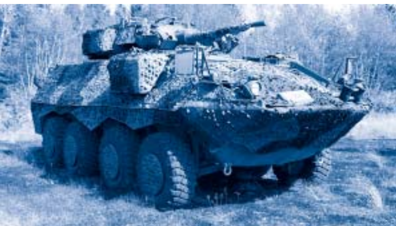
Camouflage multispectral intégré pour véhicules, installé sur le véhicule de reconnaissance Coyote
