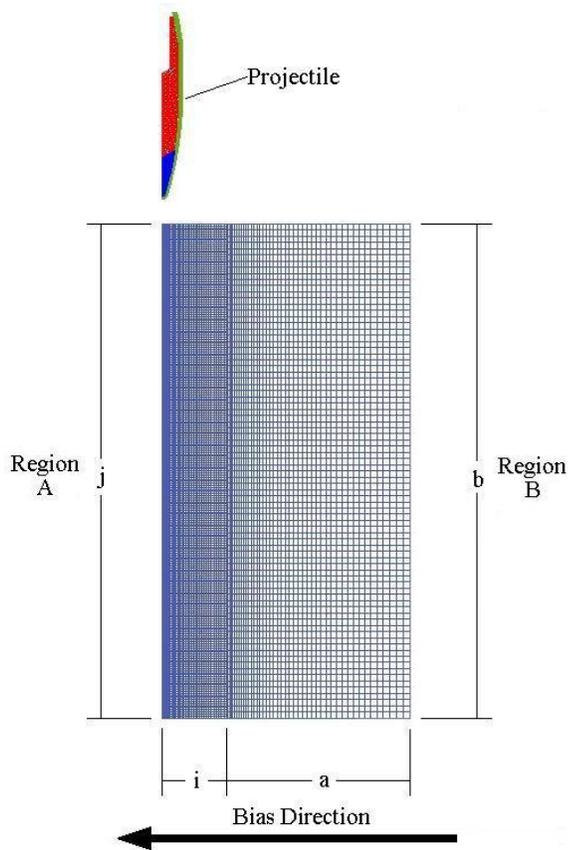
Figure 2. Mesh parameters
